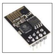
Fig 6: ESP8266 module
